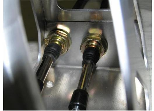
Schaltzüge durch die Löcher im Mitteltunnel führen, dabei die Schutzschläuche in die Bohrungen einbauen.
