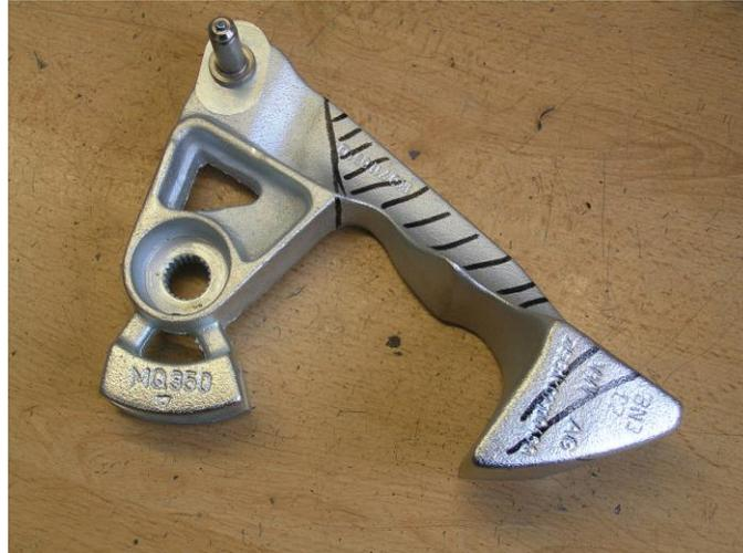
Die originalen Bolzen für die Seilbefestigung an beiden Bolzen ausbohren ( $\varnothing$  8mm) und die mitgelieferten Kugelköpfe montieren: Optional kann der Bolzen im SCHALT-hebel einer neuen Bohrung 10mm zum Drehpunkt hin versetzt werden; dies reduziert nochmals den Schaltweg
