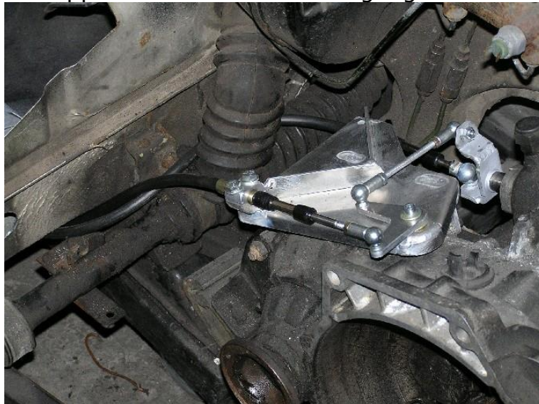
Schaltseilhalteplatte am Golf I mit bereits montierten Schaltseilen und die Verlegung des Wählseils hinter der Lenksäule
