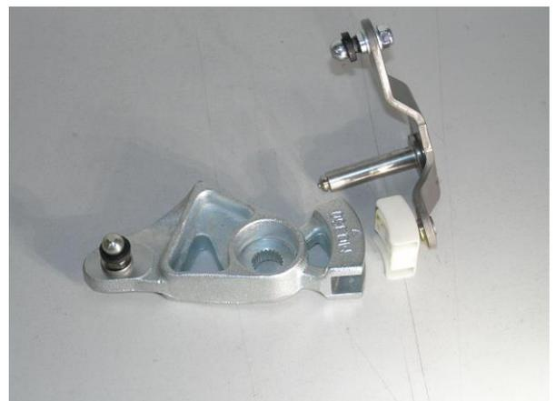
Die originalen Bolzen für die Seilbefestigung an beiden Bolzen ausbohren (ø 8mm) und die mitgelieferten Kugelköpfe montieren
