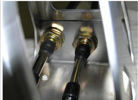
Alle Anbauteile an der Getriebeseite der Schaltseile S & W demontieren. Das längere Schalt-Seil (S) wird mittig am Schaltturm befestigt, entsprechend des kürzere Wähl-Seil (W)Links. Die Schaltseile müssen so weit wie möglich aus dem Schalturm herausstehen, innen ist kein Gewindegang sichtbar.
