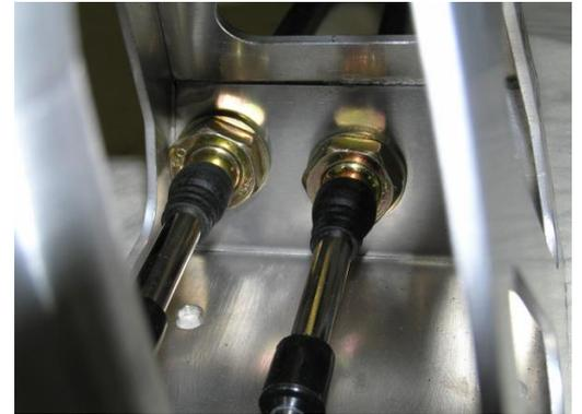
Für die Demontage und Montage der M16 Muttern die Kugelpfannen entfernen.
