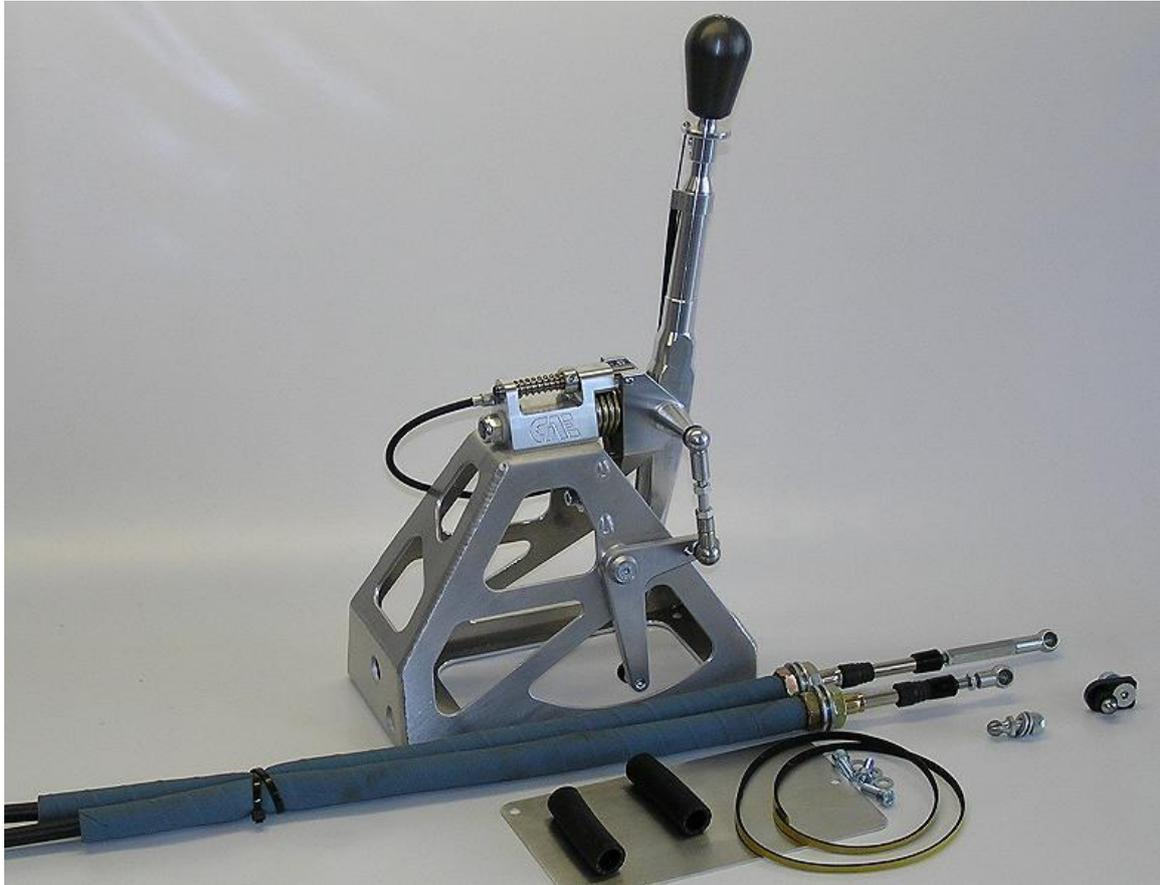
Der Shifter ist für Rennfahrzeuge ohne Innenausstattung vorgesehen. Bei eingebauter Mittelkonsole muss diese entfernt werden oder soweit ausgeschnitten werden bis eine entsprechende Freigängigkeit für die Schaltseile gewährleistet ist.
