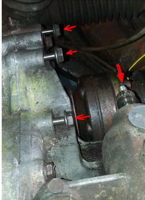
Zuerst den Getriebe Seilzughalter anbauen, dann den kurzen Getriebeeingangshebel montieren und die Unibal Koppelstange anschrauben.
