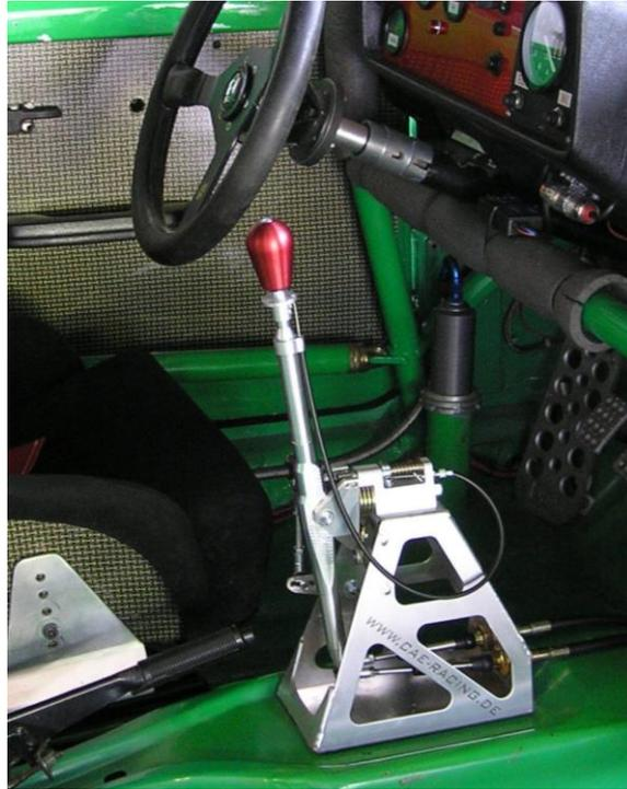
Der Shifter ist für Rennfahrzeuge ohne Innenausstattung vorgesehen. Bei eingebauter Mittelkonsole muss diese entfernt werden oder soweit ausgeschnitten werden bis eine entsprechende Freigängigkeit für die Schaltseile gewährleistet ist.
