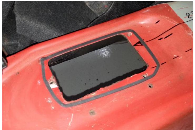
Das Schaltseil(S) vom Innenraum durch die rechte Bohrung im Tunnel führen, Das Wählseil (W) lässt sich nur vom Motorraum/unten aus durchführen, Linke Bohrung Tunnel
