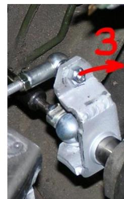
**Nun zunächst die Länge der Koppelstange am Getriebe einstellen:**
