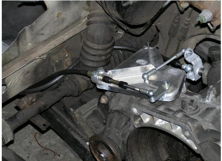
Schalt -und Wählseil in die Klemmen der Halteplatte einschrauben.
