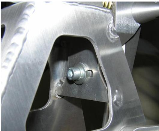
*Jetzt die Mittellage des Schalthebels am Shifter einstellen. Unter dem Schaltbock mit Inbusschlüssel den unteren Federanschlag festschrauben.*
