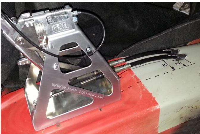
Zum Schutz der Schaltseile die beiden schwarzen Schlauchstücke im Bereich der Blechdurchführungen über die Schaltseile schieben.
