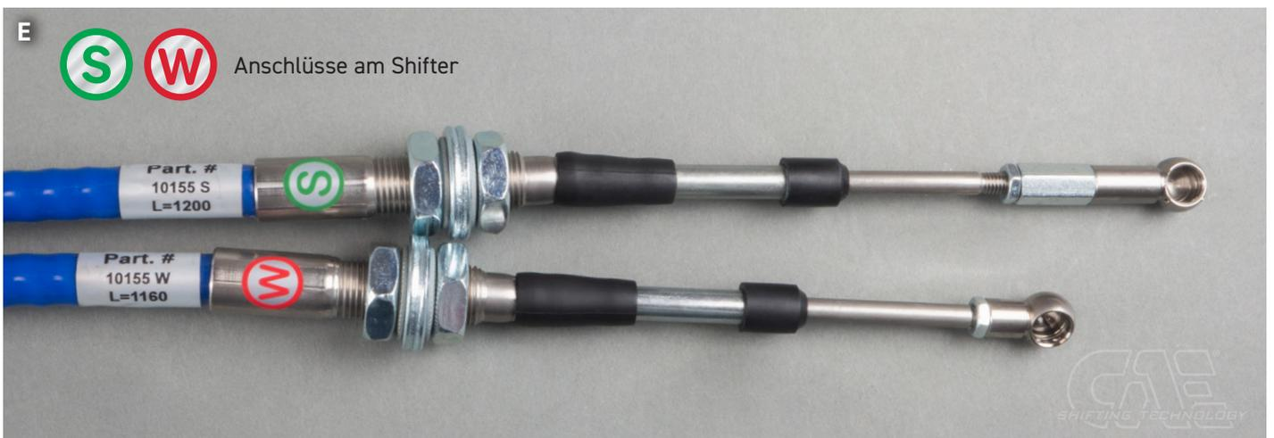
**i** Der Shifter ist für Rennfahrzeuge ohne Innenausstattung vorgesehen. Bei eingebauter Mittelkonsole muss diese entfernt werden oder soweit ausgeschnitten werden bis eine entsprechende Freigängigkeit für die Schaltseile gewährleistet ist. Der Schaltbock sollte direkt auf das Blech des Mittel隧nells geschraubt werden, evtl. vorhandener Teppich muss ausgeschnitten werden.
