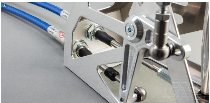
▶ Alle Anbauteile an der Getriebeseite der Schaltseile S & W demontieren. Das längere Seil ③ wird mittig am Shifter befestigt, entsprechend das kürzere Wählseil ∰links. Die Alu-Zentrierscheibe am Schaltseil entsprechend der Gehäusebohrung montieren. Die Schaltseile müssen so weit wie möglich aus dem Schaltturm herausstehen, innen im Shiftergehäuse ist kein Gewindegang sichtbar. (Bild 4, 5)
