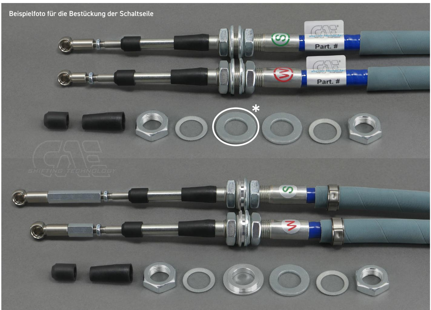
\* Beim Unterflur-Shifter entfällt diese Unterlegscheibe innerhalb der Shifterbox!
