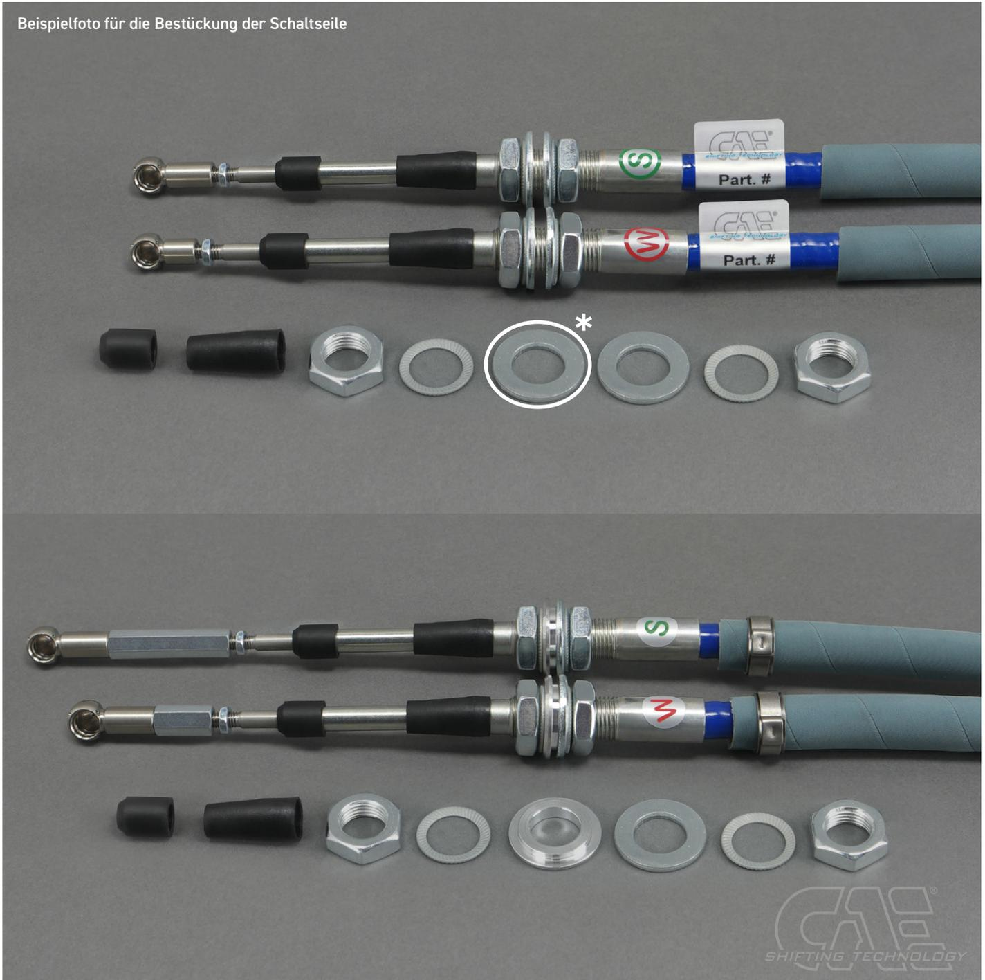
\* Beim Unterflur-Shifter entfällt diese Unterlegscheibe innerhalb der Shifterbox!
