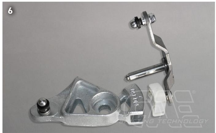
► Die originalen Bolzen für die Seilbefestigung an beiden Bolzen ausbohren ( $\varnothing$  8mm) und die mitgelieferten Kugelhöfen montieren. Schalt und Wählhebel wieder am Getriebe anbringen, das Seilwiderlager noch nicht.
