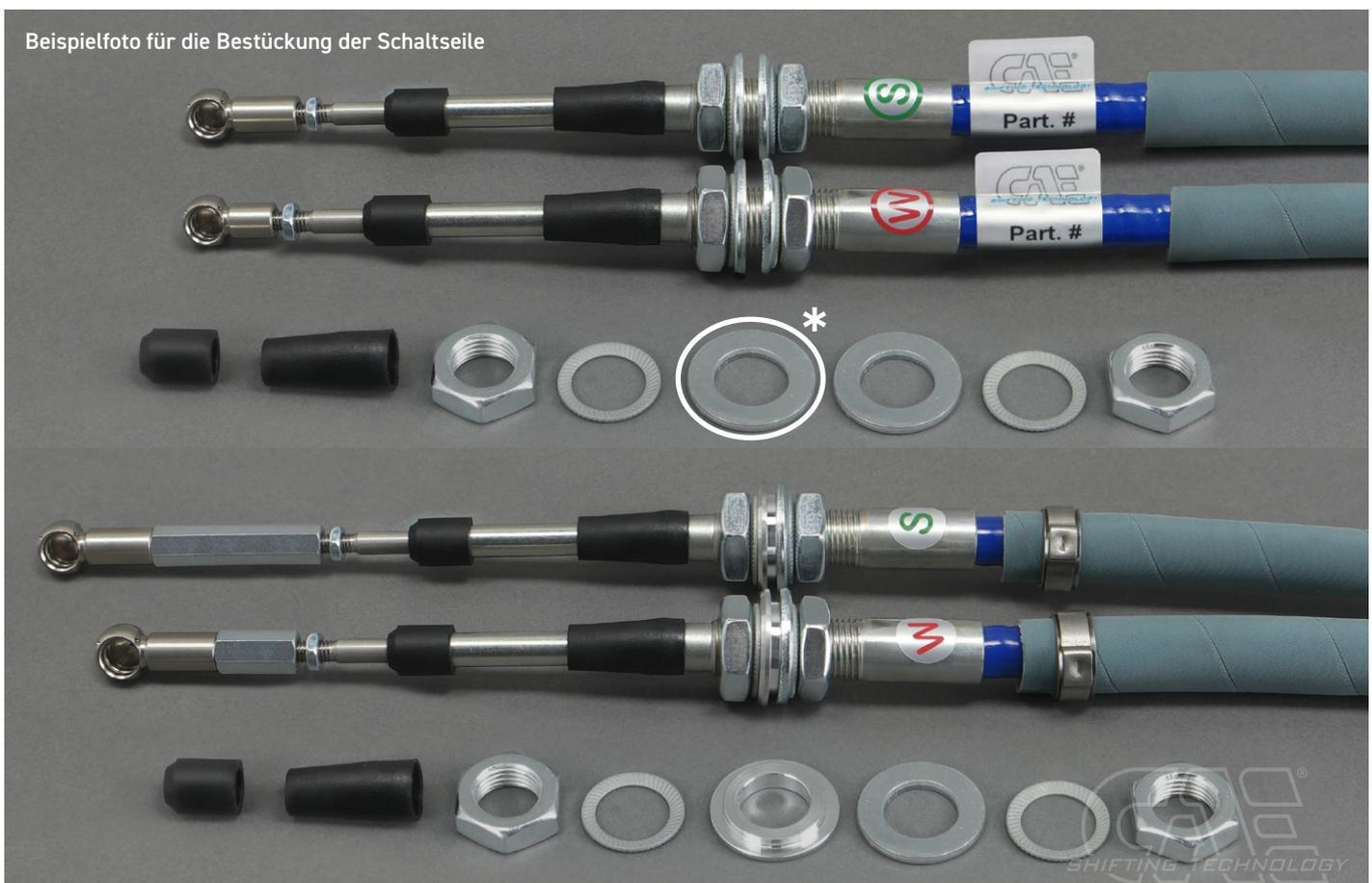
\* Beim Unterflur-Shifter entfällt diese Unterlegscheibe innerhalb der Shifterbox!
