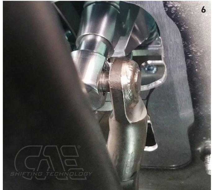
**PRÜFUNG:** Bei eingelegtem 3. und 4. Gang muss das seitliche Spiel am Schalthebel gleich groß sein. Sollte das nicht der Fall sein muss der Federanschlag nachjustiert werden. (0,5 mm sind hier schon eine Menge).
