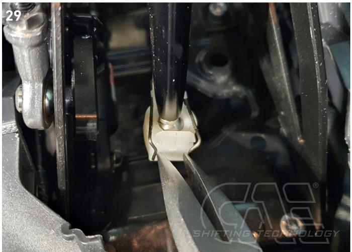
**!** **ACHTUNG:** Sollte der Shifter generell ohne Mittelkonsole verbaut werden, müssen die 4 Gehäuseschrauben sowie die obere Schraube der Koppelstange beim Einbau und vor der Einstellung des Shifters festgezogen werden!
