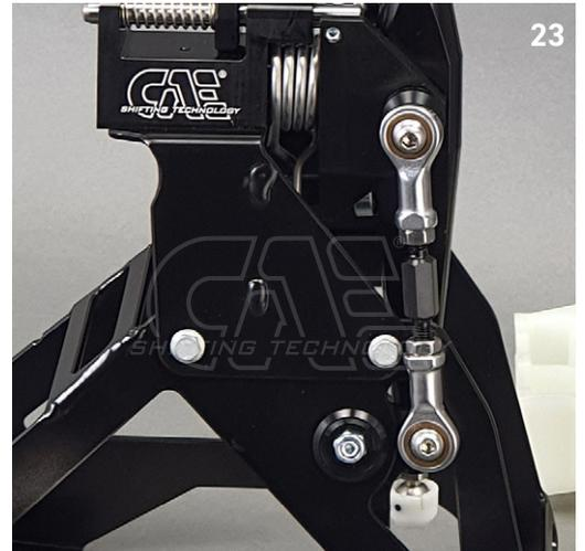
**! PRÜFUNG:** Bei eingelegtem 3. und 4. Gang muss das seitliche Spiel am Schalthebel gleich groß sein.
