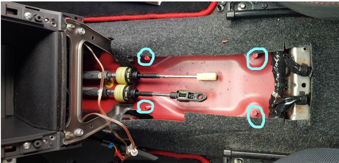
CAE Shifter aufsetzen und dabei die Schaltseile in das Shiftergehäuse einführen
