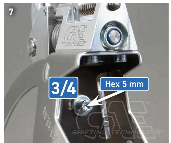
**i** **KONTROLLE:** Bei eingelegtem 3./4. Gang muss das seitliche Spiel am Schalthebel gleich groß sein, sonst die Koppelstange nachjustieren. Kontermuttern der Koppelstange nur leicht festziehen!!! Die Koppelstange ist aus Aluminium!!!! (Bild 8)
