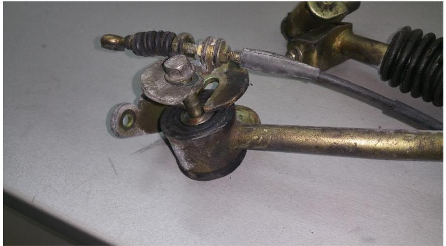
Die Schaltung soweit zerlegen das Gummimanschette einzeln ist, diese wird weiterverwendet
