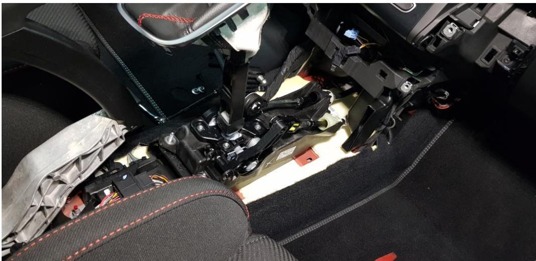
Die Schaltseile vom Originalschaltbock abmontieren und die 4 Muttern lösen.
