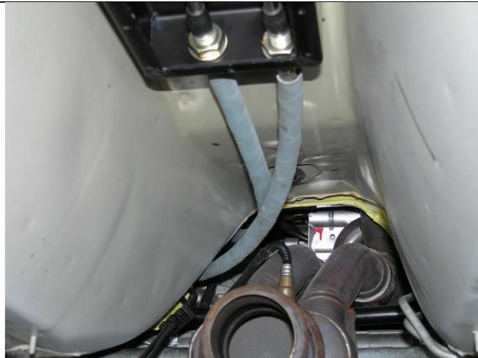
Seile entsprechend diesem Bild am Getriebewiderlager einhängen.
