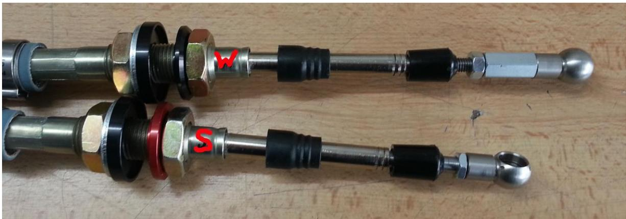
M16er Muttern festziehen und darauf achten das keine Spannung auf den Seilen ist.
