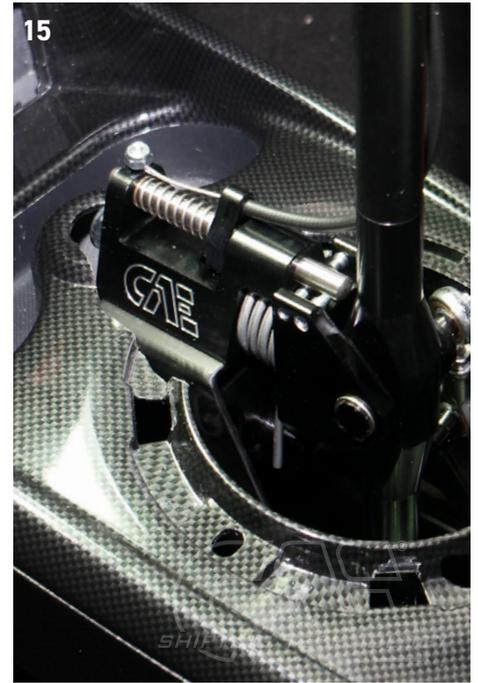
► Abdeckblech unter die Shifter-Box schrauben und wiederum mit Moosgummistreifen abdichten, Schrauben einkleben, Hitzebleche, Auspuff, Unterbodenverkleidung, Batterieträger und Batterie und Luftfilter wieder einbauen.
