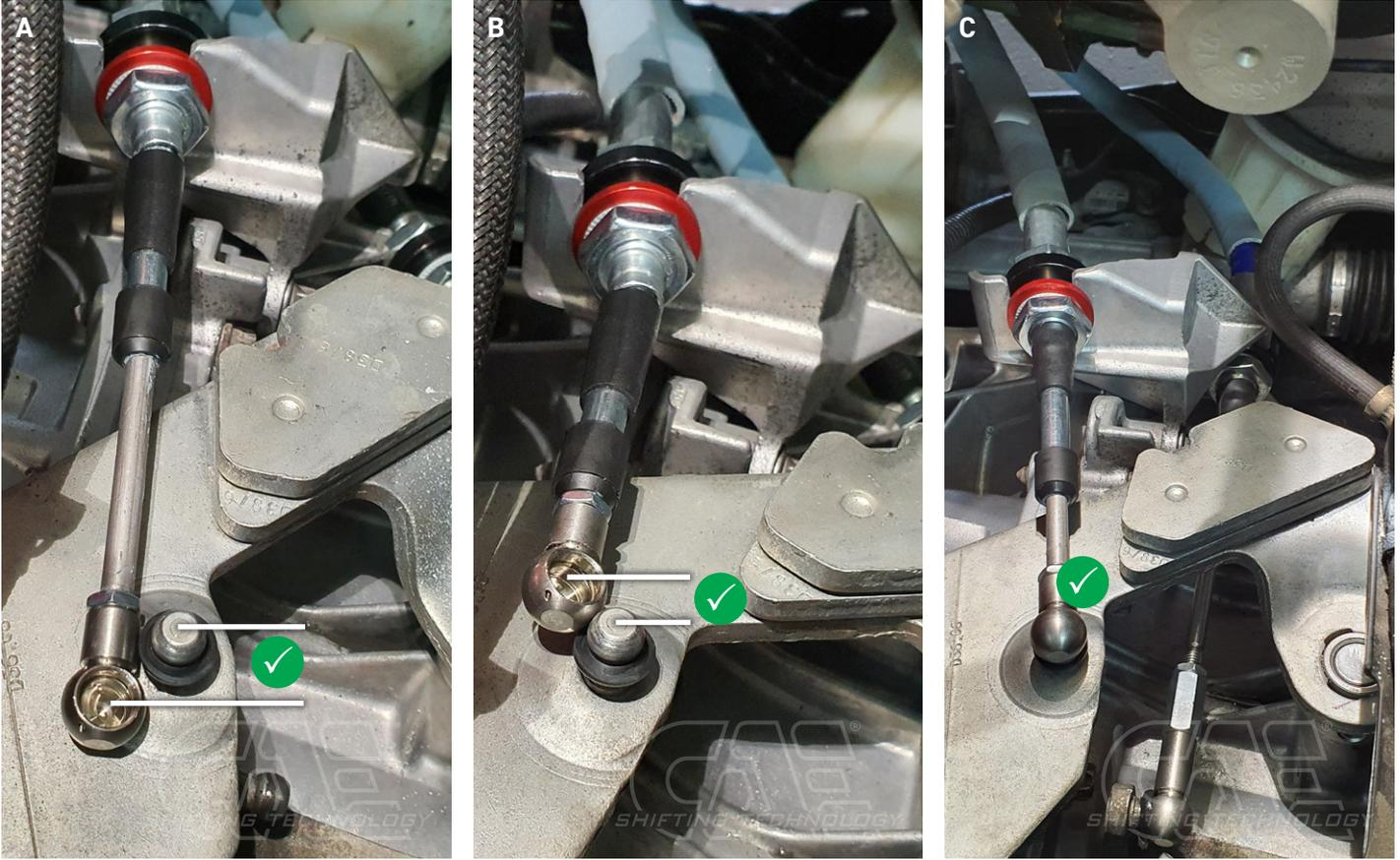
**ⓘ PRÜFUNG:** Bei eingelegtem Gang die Kugelpfanne vom Getriebeschalthebel abziehen und prüfen ob sich das Schaltseil **S** noch mind. 3 mm weiter bewegen lässt. Dies gilt für die „vorderen“ Gänge R-1-3-5 (Bild A) bei eingefahrenem Seil sowie für die „hinteren“ Gänge 2-4 (6) (Bild B) bei ausgefahrenem Seil. Durch herein- oder herausschrauben der Kugelpfannen auf dem M6-Gewinde der Seile lässt sich die Endlage korrigieren.
