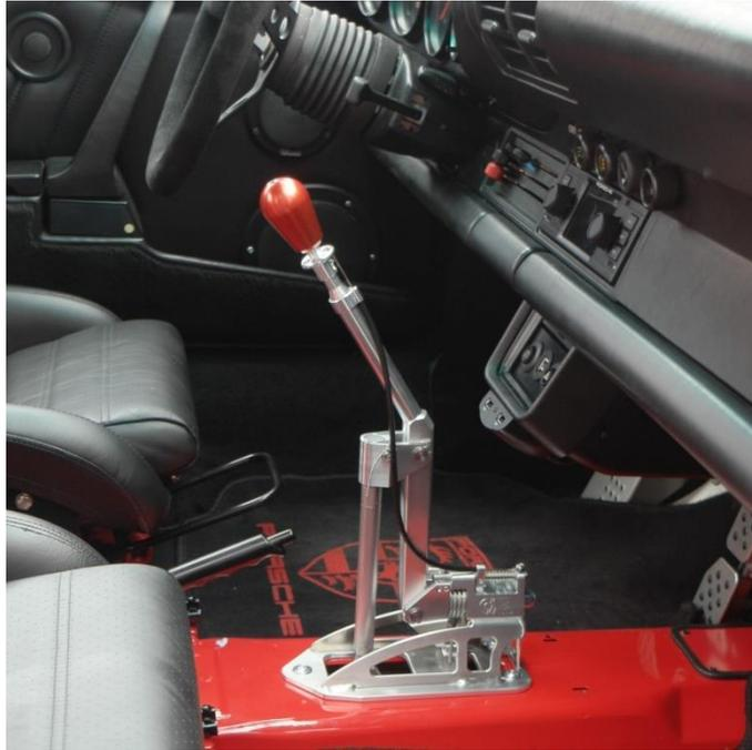
*Die Schaltung ist für Rennfahrzeuge konzipiert bei denen die Innenausstattung entfernt wurde. Bei eingebauter Mittelkonsole muss diese soweit ausgeschnitten werden das eine entsprechende Freigängigkeit gewährleistet ist.*
