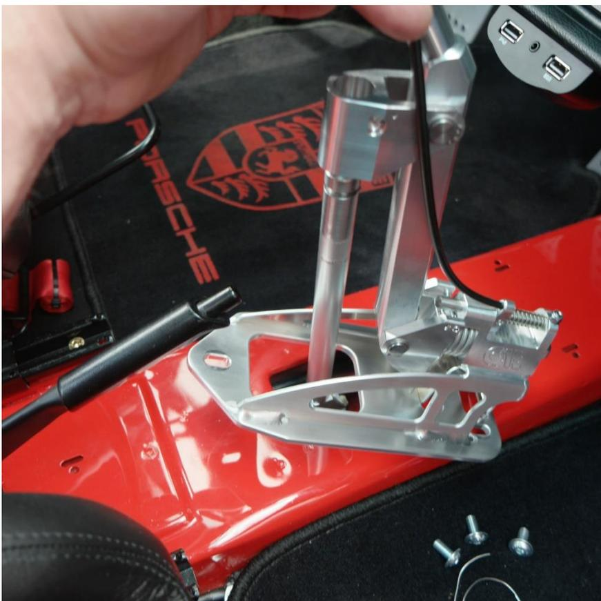
Den Shifter jetzt auf dem Mitteltunnel montieren, dabei den Schaltstangenkopf in die Bohrung der Gabel am Schalthebel einführen.
