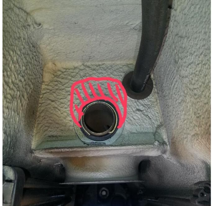
Wenn Später die Serienschaltung zurückgerüstet werden soll kann bei uns ein entsprechendes Ersatzblech für die Führung des Schaltrohres zum aufschrauben bestellt werden
