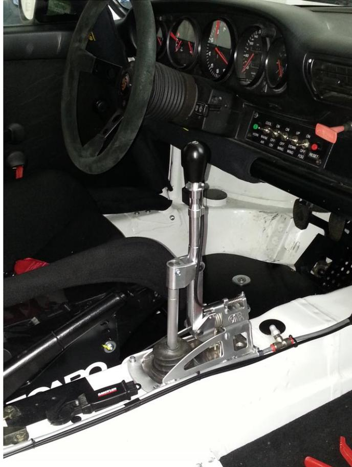
Die Schaltung ist für Rennfahrzeuge ohne Innenausstattung vorgesehen. Bei eingebauter Mittelkonsole muss diese entfernt werden oder soweit ausgeschnitten werden bis eine entsprechende Freigängigkeit für die Schaltstange gewährleistet ist.
