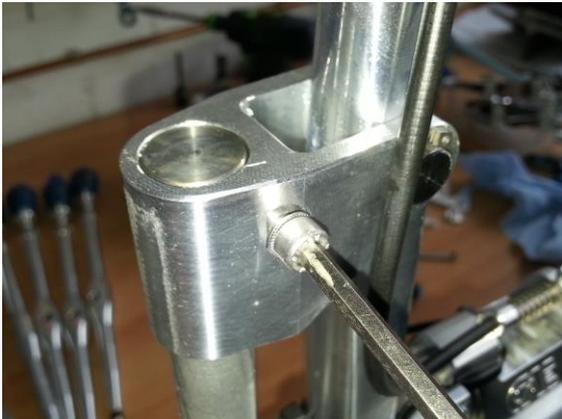
Die Fixierschraube mit 1 Zahnscheibe leicht festziehen und mit dem mitgelieferten Draht sichern . **Der Pilotbolzen muß drehbar bleiben !!!**
