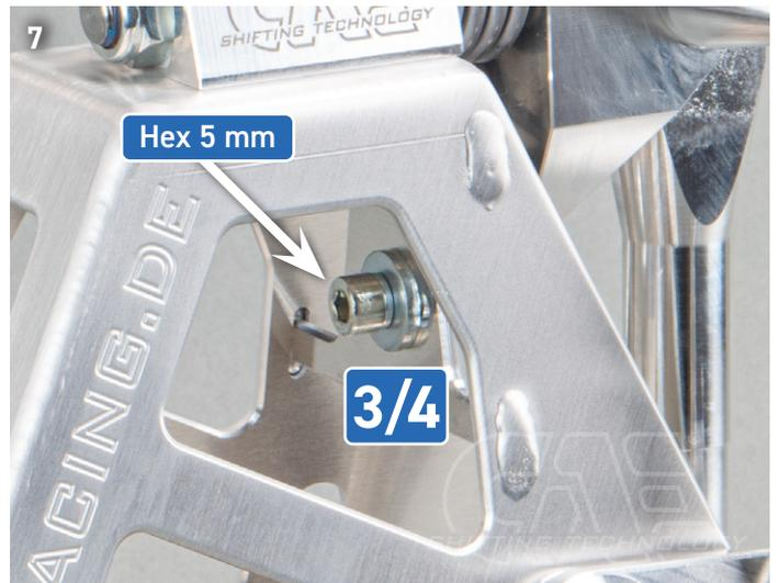
**❗ KONTROLLE:** Bei eingelegtem 3./ 4. Gang muss das seitliche Spiel am Schalthebel zu beiden Seiten gleich groß sein, sonst nochmal den Federanschlag nachjustieren. (Bild 7)
