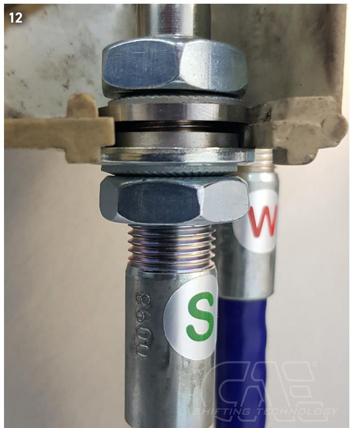
**ⓘ Alle Kugelfpannen mit den Muttern M6 kontern und Sicherungsklammern einbauen.**
