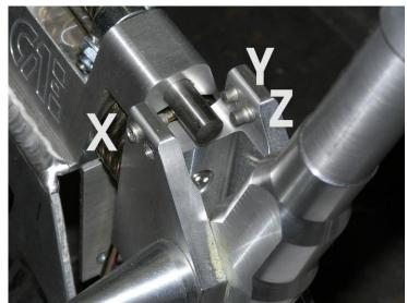
THE ADJUSTMENT SCREWS CAN BE TURNED STRONG FOR NO LOOSEN WHILE OPERATION USE HD 2.5mm INBUS
