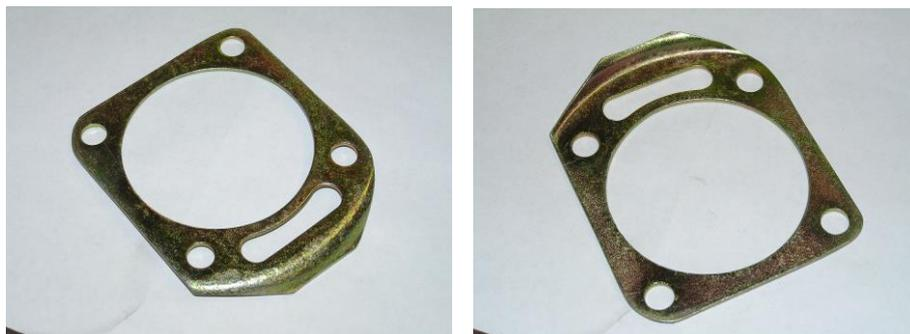
Die Bleche dienen dann nur noch als Distanzplatten für die korrekte Lagervorspannung
