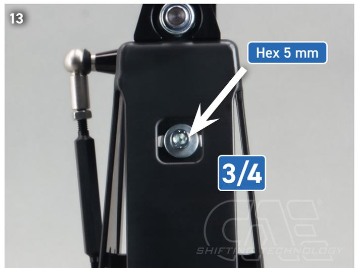
► Getriebe durch vor oder Zurückbewegung des Schalthebel in 3. oder 4. Gang schalten.
