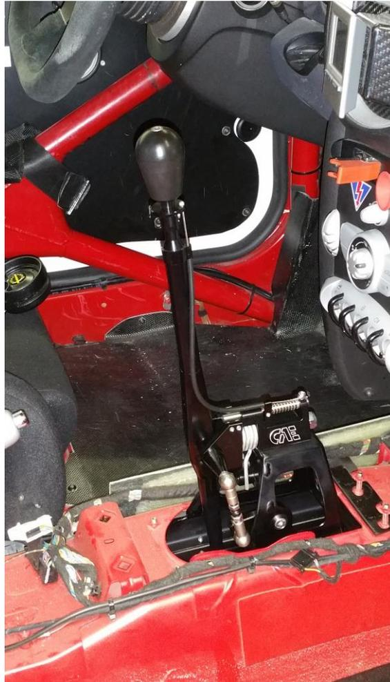
Der Shifter ist für Rennfahrzeuge ohne Innenausstattung vorgesehen. Bei eingebauter Mittelkonsole muss diese entfernt werden oder soweit ausgeschnitten werden bis eine entsprechende Freigängigkeit für die Schaltseile gewährleistet ist.
