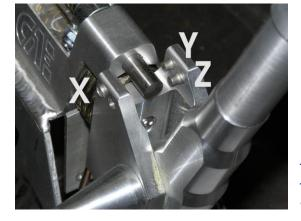
THE ADJUSTMENT SCREWS CAN BE TURNED STRONG FOR NO LOOSEN WHILE OPERATION
