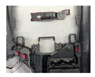
• Schaltereinheit der Mittelkonsole im rot markierten Bereich ausfräsen.
