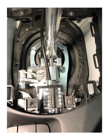
Nun die Mittelkonsole mit Schaltereinheit wieder einbauen. Der originale Schaltsack kann je nach belieben weggelassen oder weiter verwendet werden.
