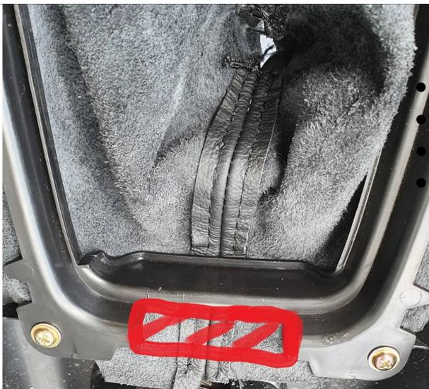
Wenn der Schaltsack gewünscht ist, dann muss an dem Befestigungsrahmen auch ein wenig ausgespart werden. (siehe markierter Bereich)
