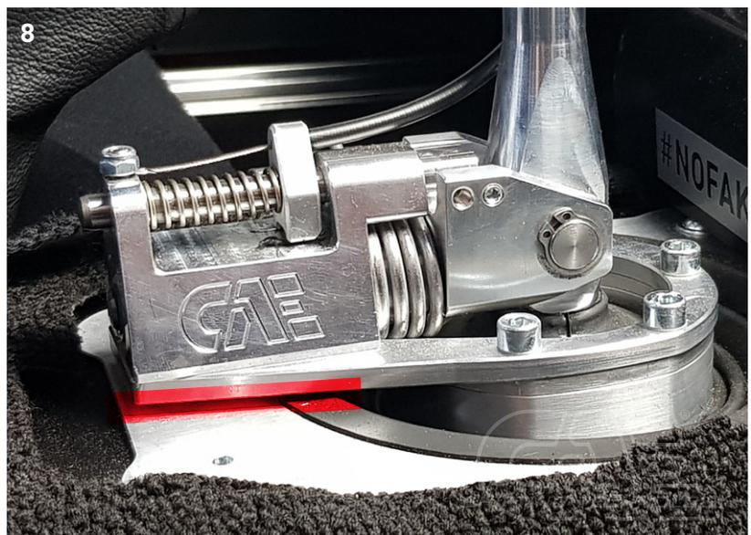
**i** Generell jede Lagerstelle des Shifters regelmässig fetten. Wir empfehlen Würth HHS 2000. Alle Muttern / Schrauben bei der Montage mit Zahnscheibe sichern oder einkleben!
