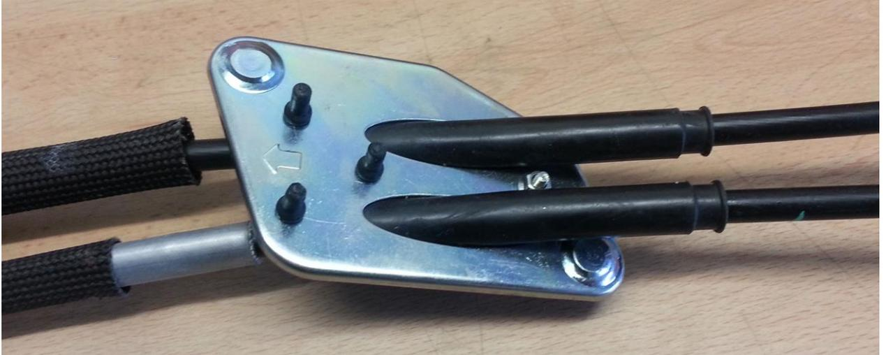
Den Shifter mit bereits montierten Schaltseilen an seinen Einbauort bringen und dabei die Schaltseile durch die Durchführung hindurch Richtung Motorraum verbringen; Shifter auf dem Tunnel verschrauben
