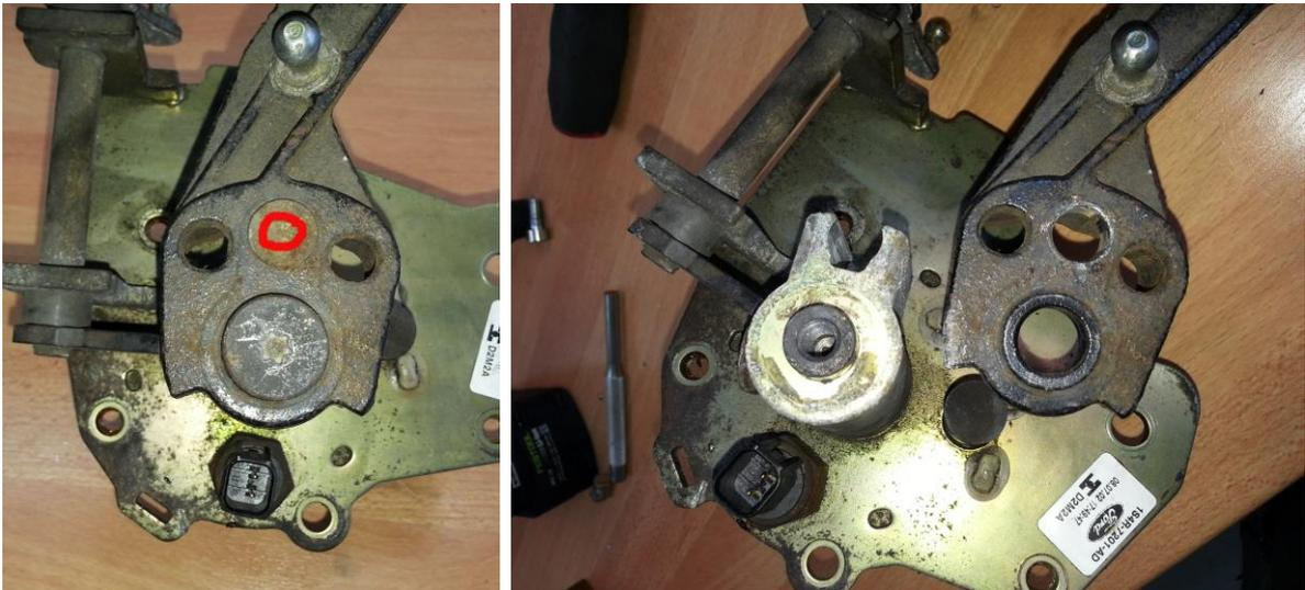
Hierfür zunächst die Niete ausbohren (roter Kreis) ( DRM 12mm ) , dann die Torx Schraube lösen und den Hebel von der Schaltwelle abziehen
