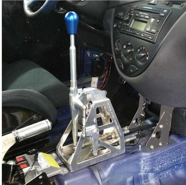
Der Shifter ist für Rennfahrzeuge ohne Innenausstattung vorgesehen. Bei eingebauter Mittelkonsole muss diese entfernt werden oder soweit ausgeschnitten werden bis eine entsprechende Freigängigkeit für die Schaltseile gewährleistet ist.
