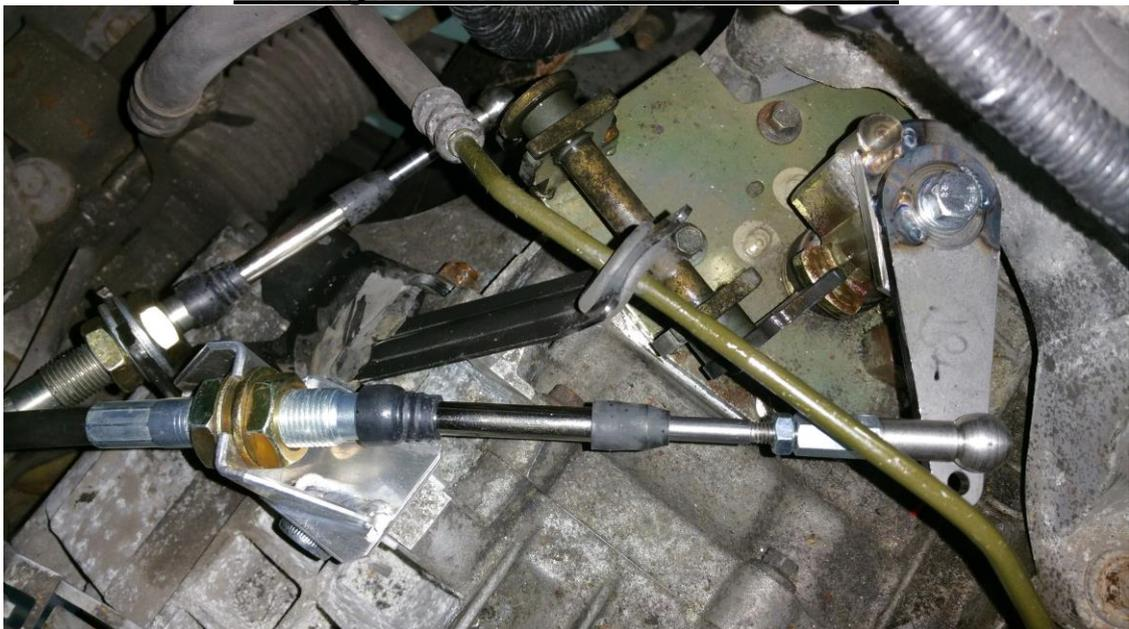
Neopren-Dichtmanschette am Wählhebel-Kugelkopf montieren, die Kugelköpfe gut einfetten
