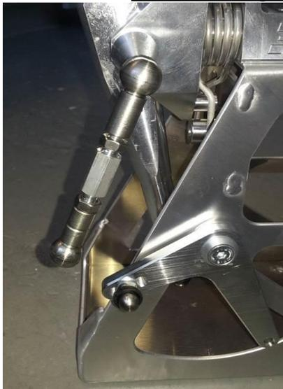
Die seitliche Koppelstange **am Shifter** von einer der Kugeln abziehen
