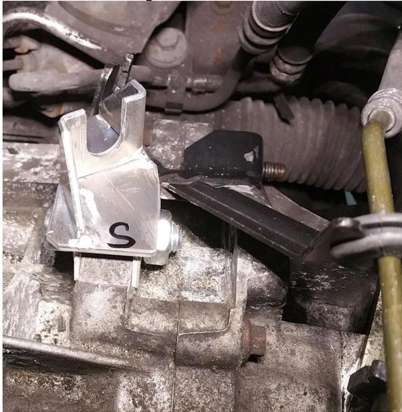
Der originale Getriebe-Schalhebel muss von der Schaltwelle abgebaut werden:
