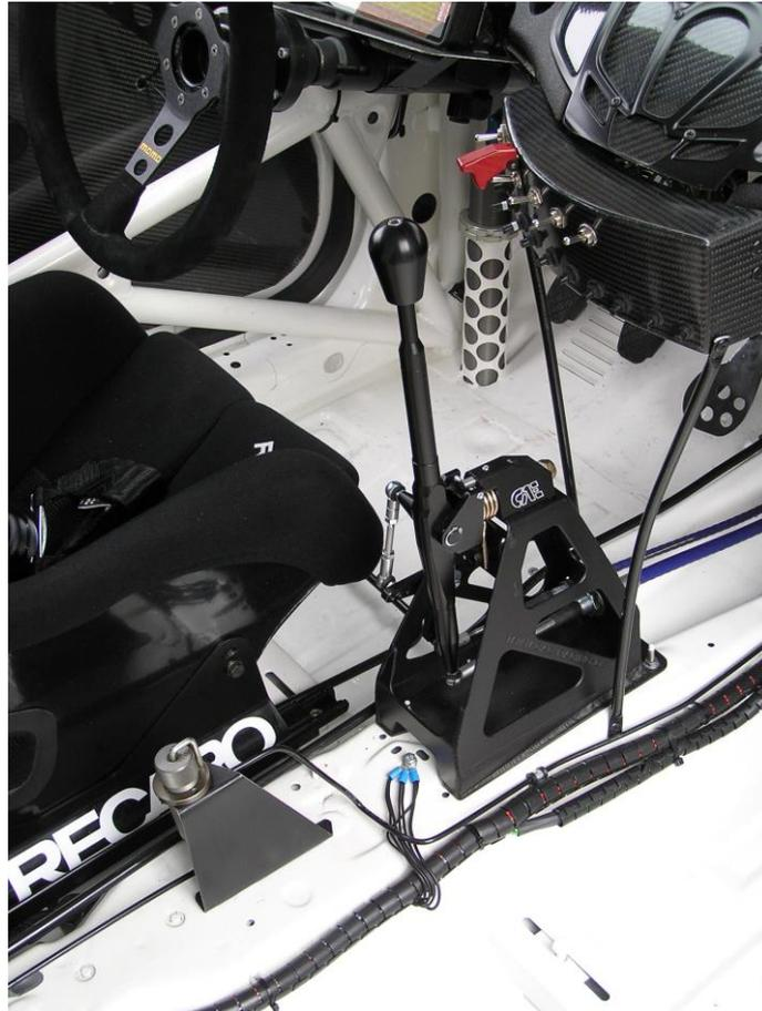
Der Shifter ist für Rennfahrzeuge ohne Innenausstattung vorgesehen. Bei eingebauter Mittelkonsole muss diese entfernt werden oder ausgeschnitten werden bis eine entsprechende Freigängigkeit gewährleistet ist.
