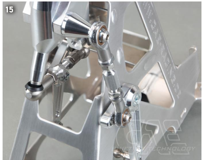
▶ Die kurze Koppelstange für die Schaltbewegung mit den 2 mitgelieferten Sicherungsbügeln sichern.
