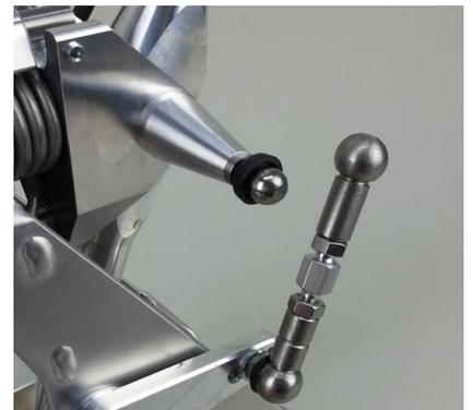
Die Kugelpfanne „Wähl“ am Getriebe so einstellen, dass sie sich ohne Längenänderung am Seil auf die Kugel drücken lässt.
