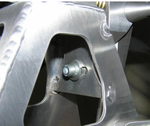
Den Federanschlag unter dem Schaltbock so einstellen, dass der Schalthebel gerade steht
